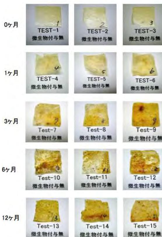
Fig. 3 生分解性試験後のセルロース誘導体
