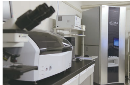
ケミカルプリンターと質量分析計MALDI TOF MS (実験実習機器部門)
