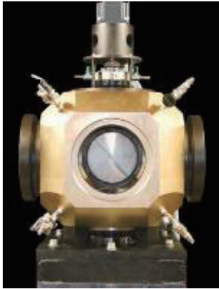
定容燃焼器 : 予混合層流・乱流火炎 (0.1MPa~0.5MPa)
