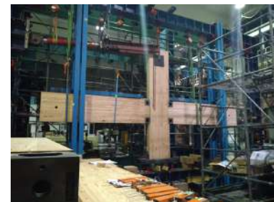
木造ビル用接合部の実験
