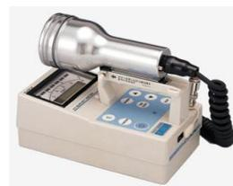
市販されているGMサーベーターです。高価な装置ですが、取扱いが簡単で万能な放射線測定装置です。放射線を検知すると音で知らせてくれる機能もあります。
